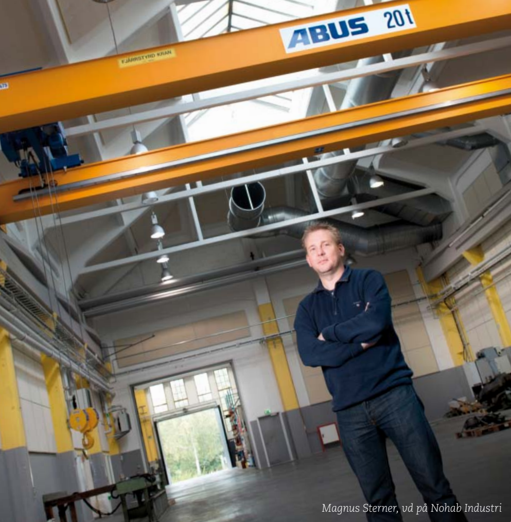
Tre stycken traverser på 10 ton och en på 20 ton.
