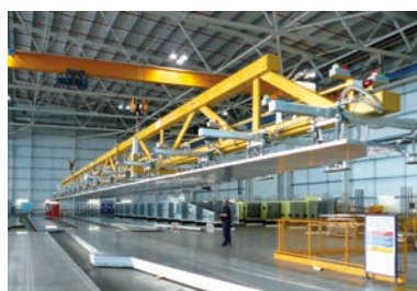
VacuGiant för lyft av aluminiumplåt.
