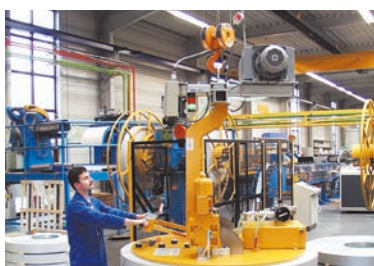
VacuCoil för frammatning till en stansmaskin.
