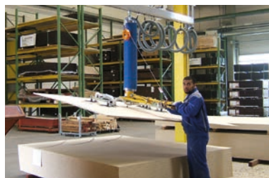
VacuPowerlift för hantering av Mdf board.
