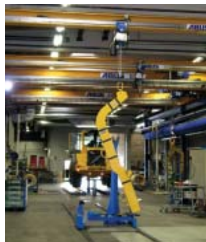
Dagligen sker många lyft av delar till hjullastarna vid den nya monteringsbanan med hjälp av ABUS traverssystem.
