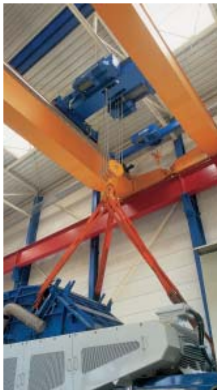
ABUS elektroniska överlastskydd typ LIS (monterade på lintelfer) kan erhållas med ett lastkollektivminne för att läsa ut aktuella drifttidstimmar.
