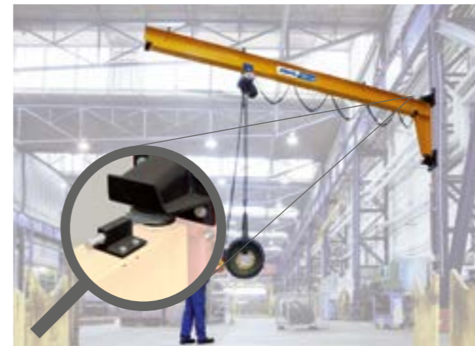
Reglering av svängmotstånd VW (bild 10)
