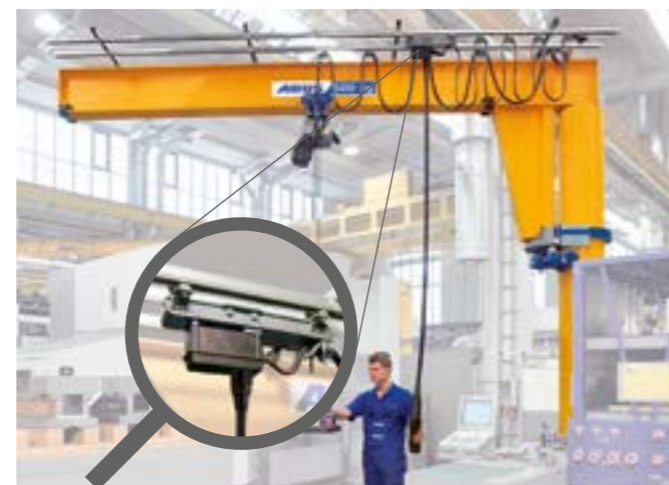
Separat åkbart manöverhandtag (bild 11)
