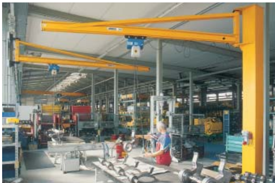
ABUS svängkranar typ LS (pelarsvängkran) och LW (väggsvängkran)
