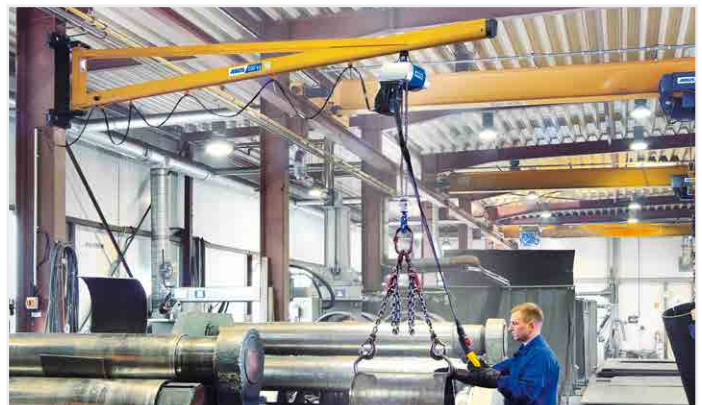
Sköter lyftjobben, även när det inte finns plats på marken: ABUS väggsvängkran, upp till 5 t (upp till 4 t. med kättingtelfer)
