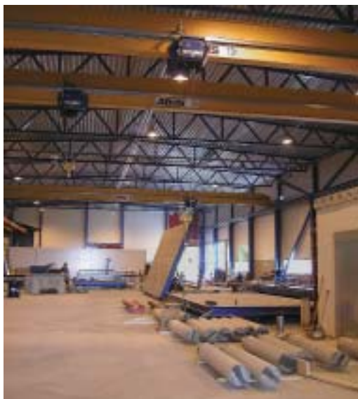
En travers lyfter ett byggelement.
