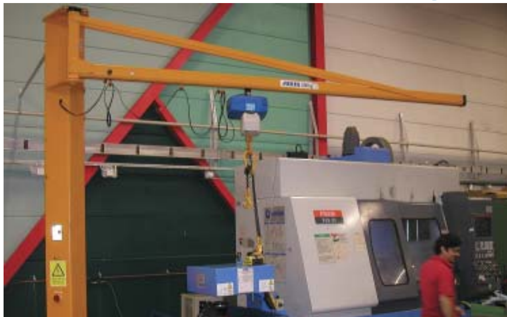
Denna svängkran har en lyftkapacitet på 500 kg.
