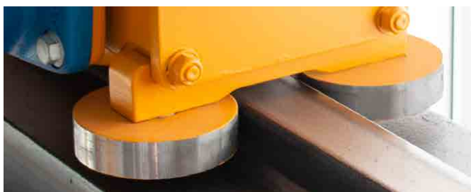
Styrullar på den övre ändvagnen mot kranbanans räl
