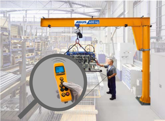
Radiostyrning ABURemote (bild 12)
