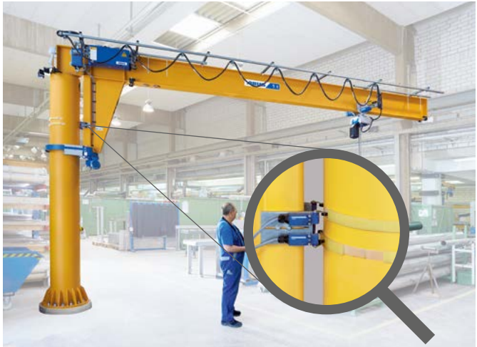
Gränslägesbrytare för svängmaskineri (bild 6)
