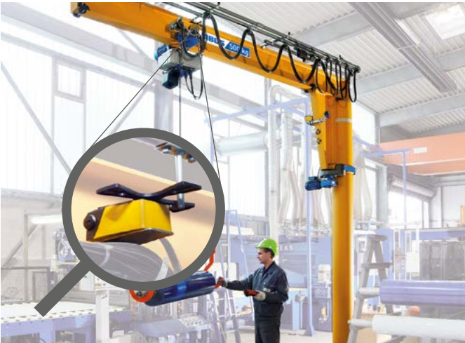
Gränsbrytare för elektriskt telferåkverk (bild 8)
