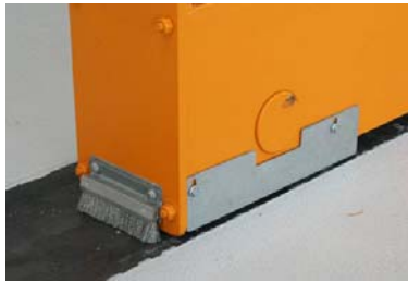
Börste mot stålband ger bra kontaktyta
